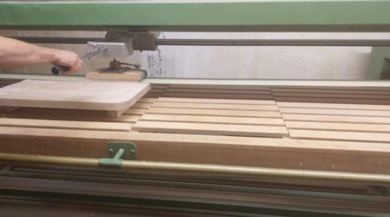
Schleifen der Platte mit der Langband
